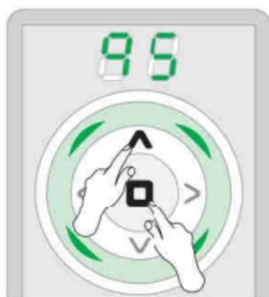
Halten Sie die Tasten OBEN und STOPP gedrückt, bis Sie im Konfigurationsmodus sind.
