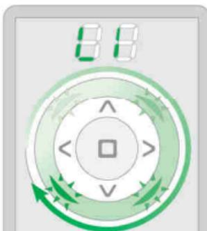
Die Fernbedienung geht in den Abhörmodus über. Die grünen LED leuchten nacheinander im Uhrzeigersinn auf. Die Fernbedienung bleibt im Abhörmodus bis nach Ablauf von 30 Sekunden ab Ende der Datenübertragung.
