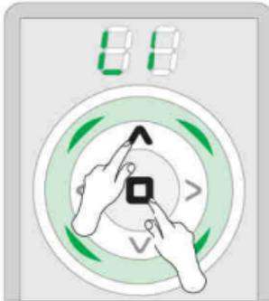
Drücken Sie gleichzeitig die Tasten STOPP und OBEN, bis Sie im Konfigurationsmodus sind.
