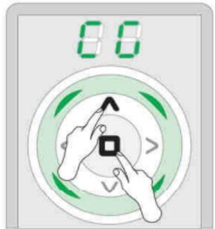
Halten Sie die Tasten OBEN und STOPP gedrückt, bis Sie im Konfigurationsmodus sind.
