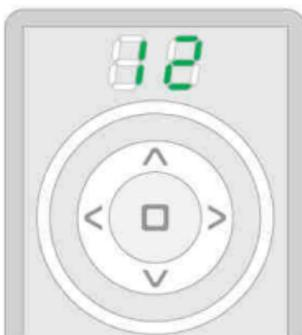
Geben Sie innerhalb von 12 Sekunden das exkludierte/zurückgesetzte Gerät in den Programmiermodus ein\*1.
