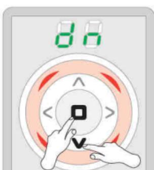
Drücken Sie gleichzeitig die Tasten STOPP und UNTEN, bis Sie im Konfigurationsmodus sind.
