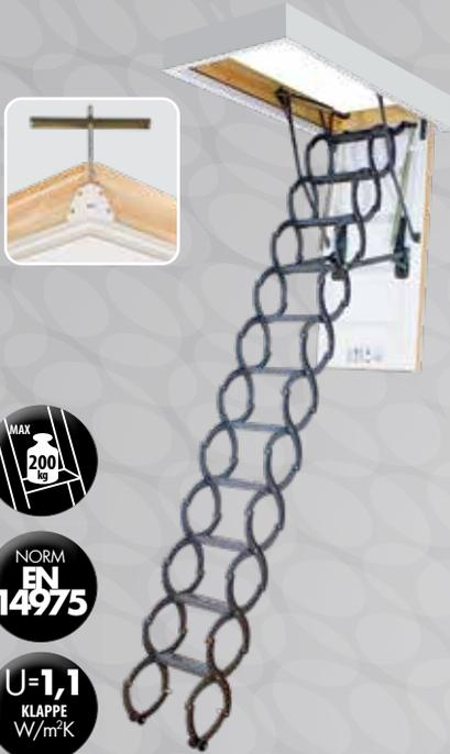
In den Tragrahmen der Bodentreppe sind werksseitig Treppenkasten, Blendeleisten und Montagewinkel integriert, was eine schnelle und einfache Montage ermöglicht. Der Öffnungsmechanismus sowie die Klappenarretierung sorgen für eine einfache Bedienbarkeit der Treppe im geöffneten Zustand. Die Leiter wird platzsparend zusammengeklappt, so dass die Montage auch in kleine Deckenöffnungen möglich ist.
