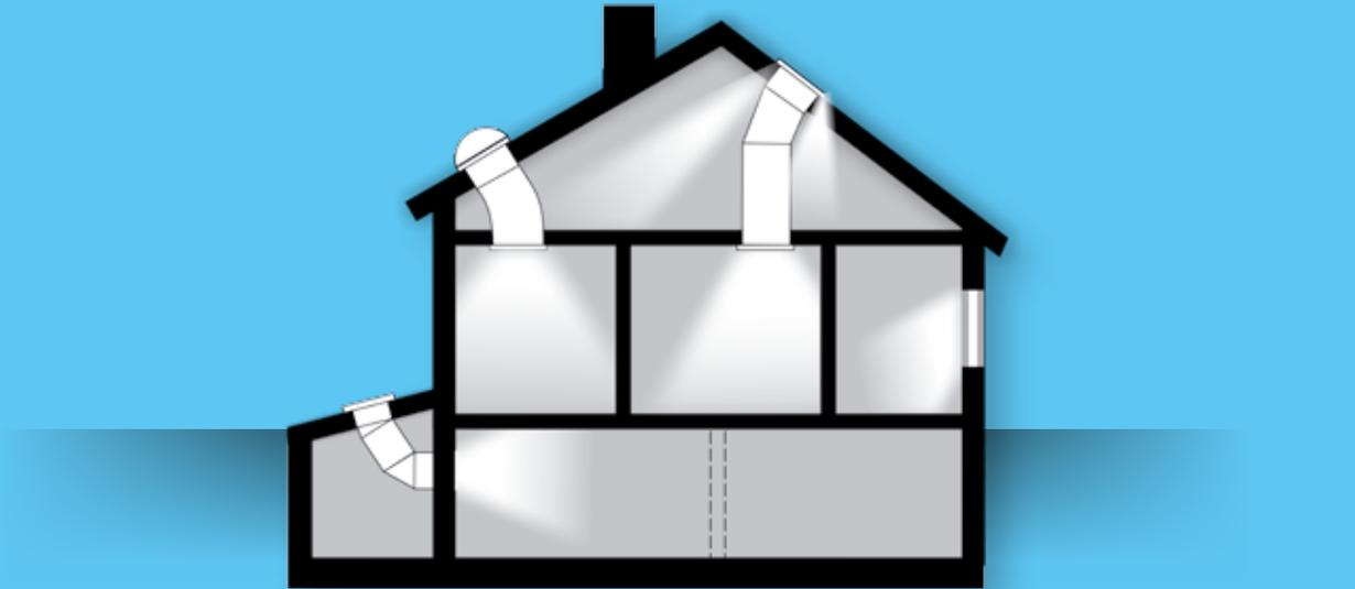
Tageslicht-Spots übertragen natürliches Tageslicht über verspiegelte Rohre in die gewünschten Zielräume. Dabei wird das einfallende Licht so lange reflektiert, bis es über den Prismendiffuser in den Raum gelangt. Dieser sorgt durch seine optischen Eigenschaften dafür, dass das Licht gestreut und nicht nur punktuell im Raum verteilt wird, so dass der Raum oder der Teil des Raumes möglichst gleichmäßig belichtet wird.
