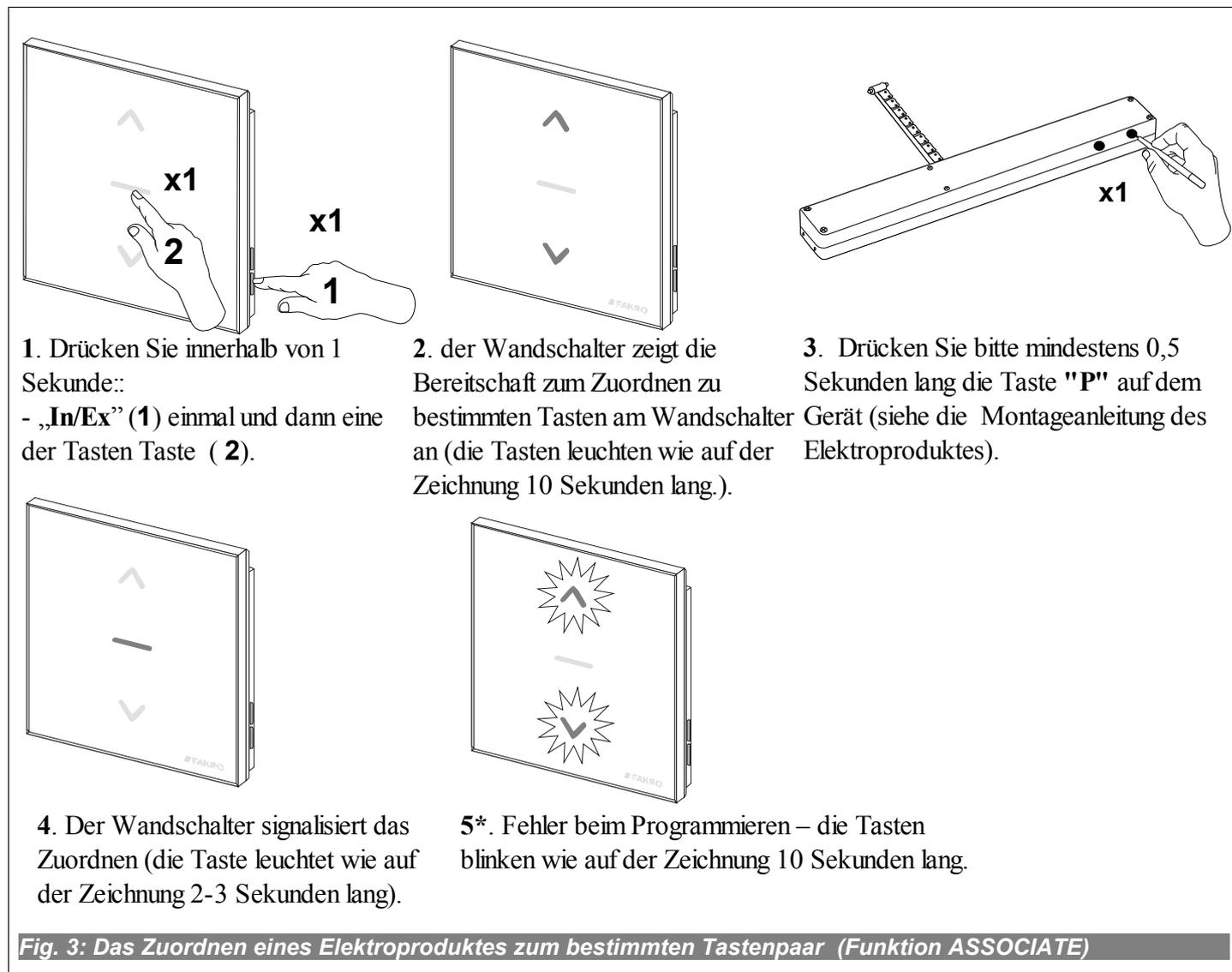
\*) Fehler beim Programmieren kommt zum Stande, wenn keine Bestätigung vom Elektrogerät kommt und kann durch folgende Faktoren verursacht werden:
