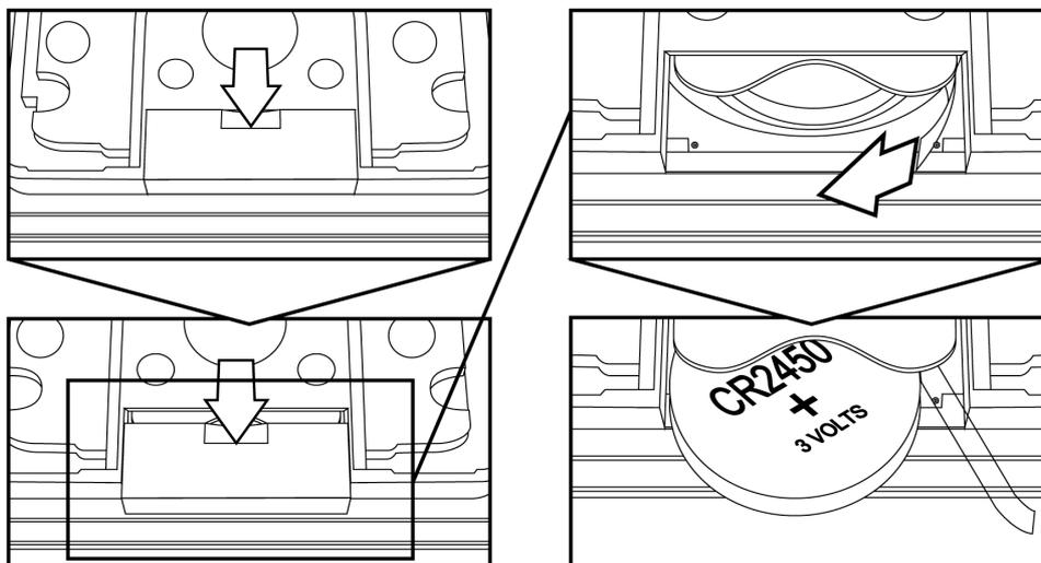
3. Batterie einsetzen. Das Band so legen, dass es das Herausnehmen der Batterie ermöglicht.
