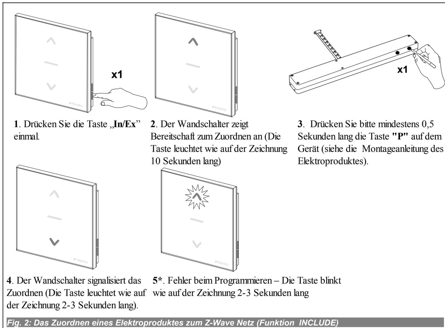
Fig. 2: Das Zuordnen eines Elektroproduktes zum Z-Wave Netz (Funktion INCLUDE)
